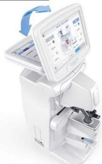
Funzione misurazione UV e BlueLight: bloccaggio UV e BlueLight può essere misurato e visualizzato sullo schermo.
